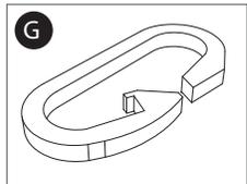
**Gancho (G):** Conector que une los extremos del tubete sirviendo como puente entre ambos extremos. Incluye 4 por protector.
