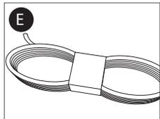
**Tube o elástico (E):** Lazo para unión entre los ojettillos del protector y el interior del bus. Incluye 5m por protector.
